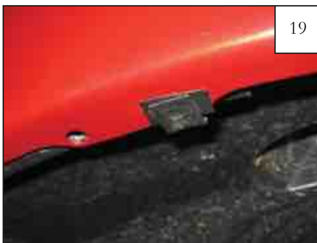
Install Clip (CL1-0022) over Tab (MT1-0014).
